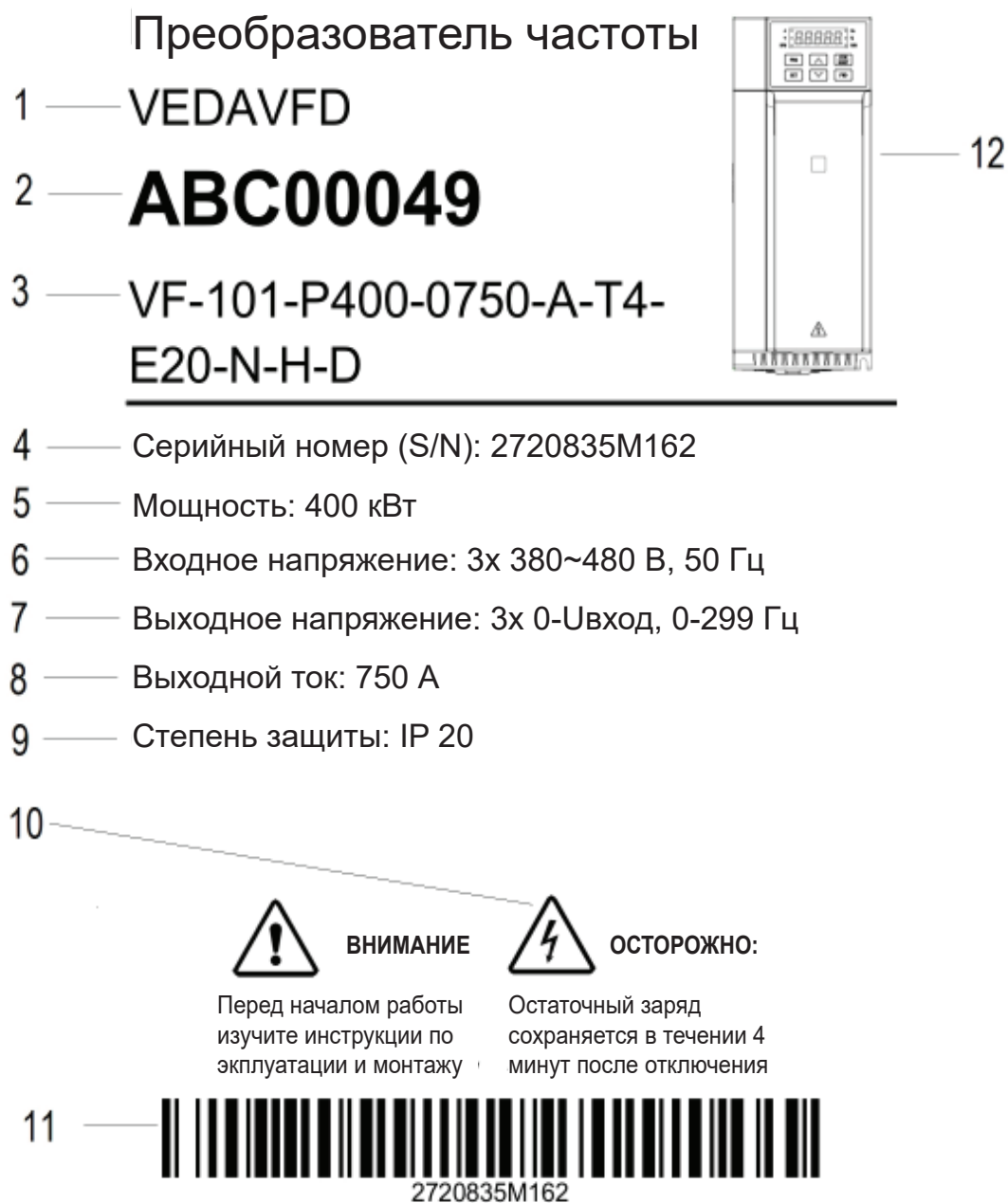
Рис. 1-3 Пример маркировки преобразователя частоты
