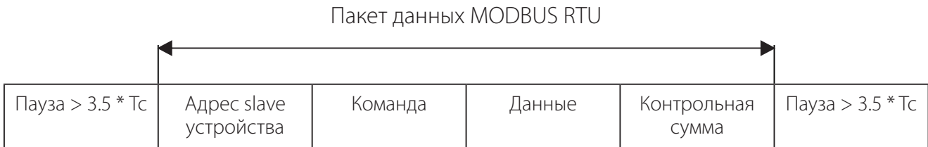
Рис 8-5 Структура пакета MODBUS RTU
